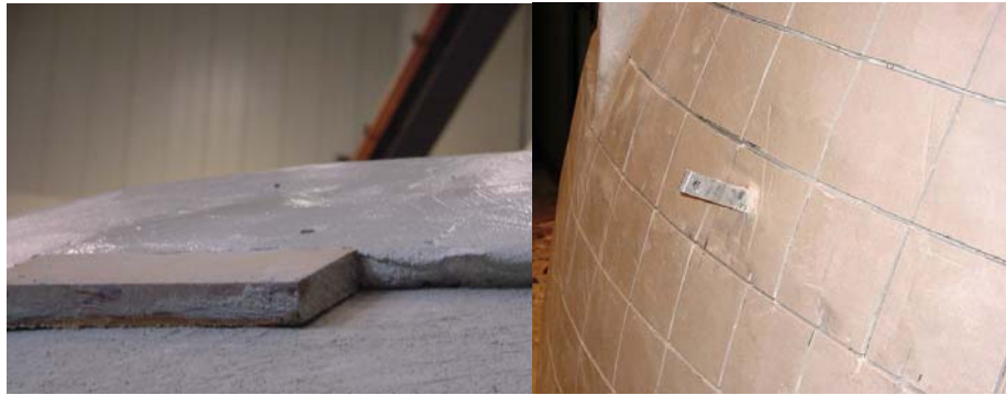
Figura 3: Vista de la capa extra y de los cortes para reducir la rigidez
