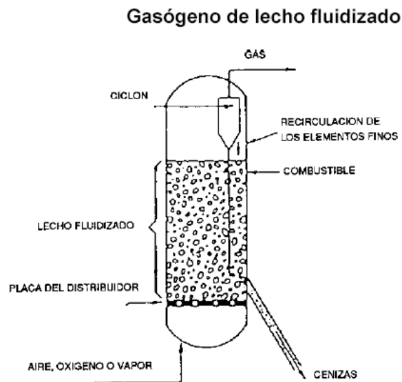
FIGURA 2: PROCESOS EN GASIFICADOR DE LECHO FLUIDIZADO
