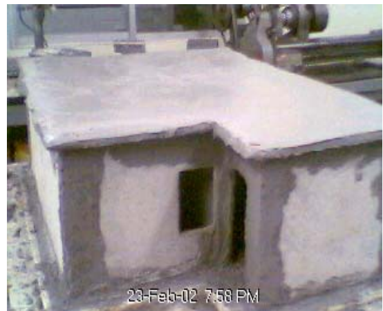
Imagen 1. Construcción Del Modelo De Vivienda Urbana A Escala 1 A 10.
