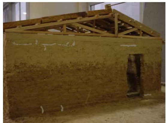
Imagen 2. Construcción Del Modelo De Vivienda Rural A Escala 1 A 10.
