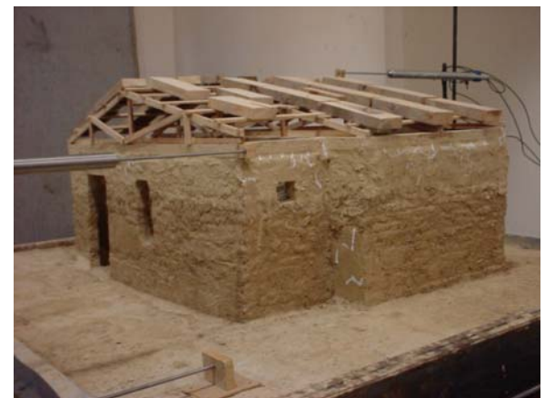
Imagen 3. Mesa Vibratoria Aislada Y Con Modelo A Escala.
