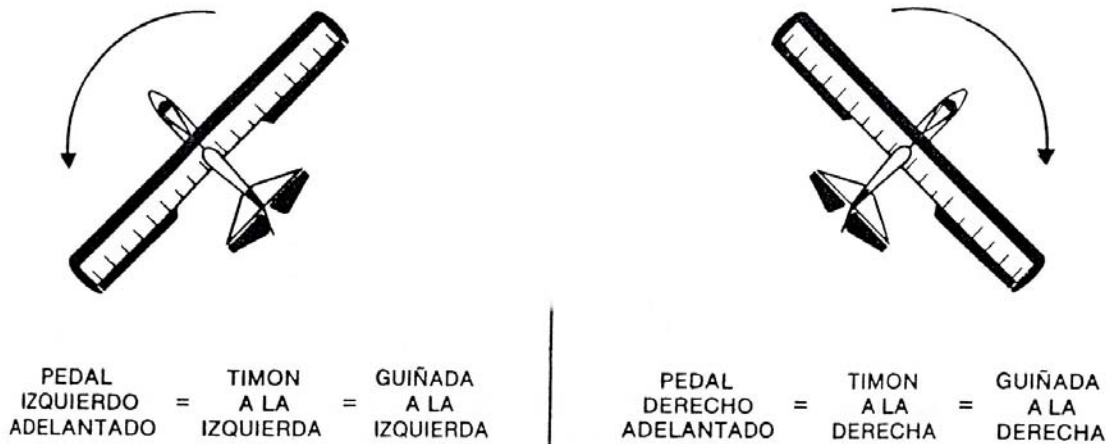
Fig. 4 Movimientos de reacción del timón (Silva, 2002)
