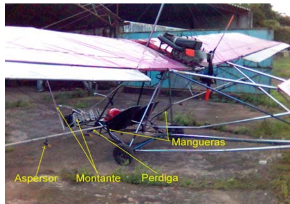
Fig. 11 Pértiga, aspersor y montante.
