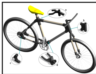
Figura 7. Modelo 3D, en el cual se pueden observar las uniones a,b,c y d, objeto de estudio de este trabajo.
