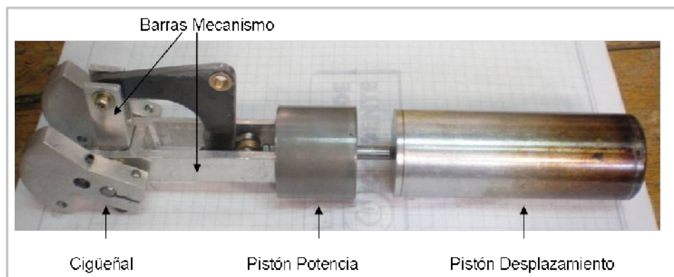
Figura 8. Sistema completo de transmisión de potencia.
