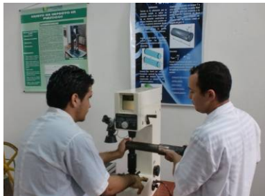
Figura 3: Los estudiantes realizan ensayos de dureza a una pieza
