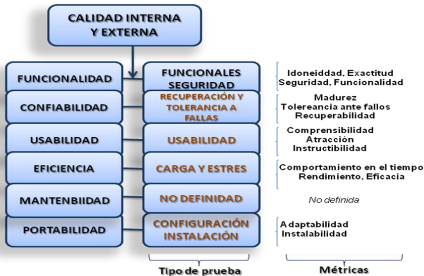
Figura. 1: Pruebas de software realizadas en el LIPS según características de calidad (Fuente: Elaboración propia).
