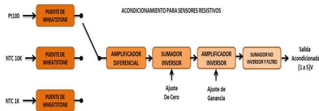
**Figura 6: Acondicionamiento de sensores resistivos**
