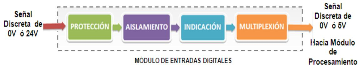
**Figura 2: Etapas de acondicionamiento para Entradas Digitales.**
