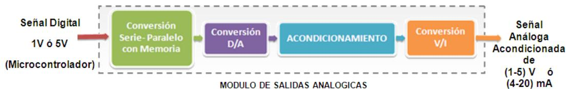
**Figura 5: Etapas de acondicionamiento para Salidas Analógicas.**
