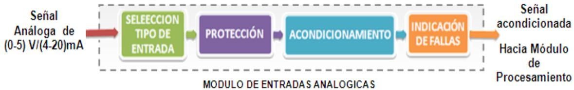
**Figura 3: Etapas de Acondicionamiento de Entradas Analógicas.**
