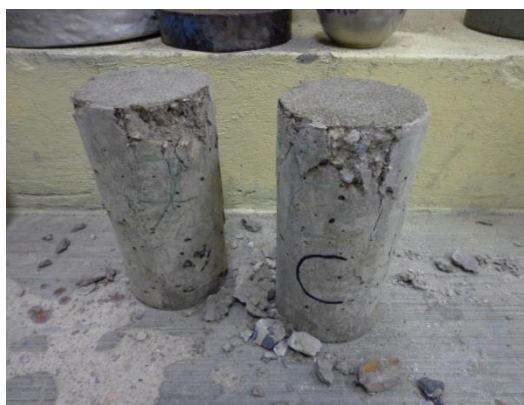
Gráfico 4. Cilindros de hormigón reciclado antes y después del ensayo de resistencia por compresión simple.
