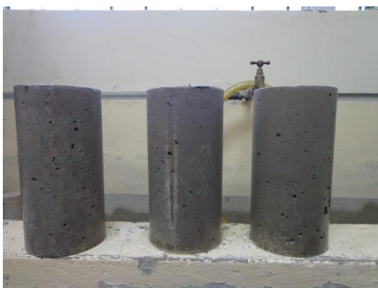
Gráfico 4. Cilindros de hormigón reciclado antes y después del ensayo de resistencia por compresión simple.
