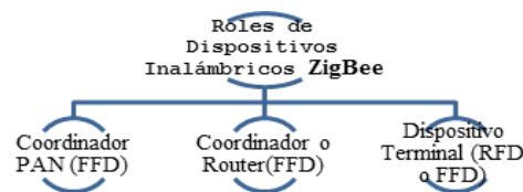
Figura 1: Tipos y Roles de los Dispositivos ZigBee (Shahin, 2008).
