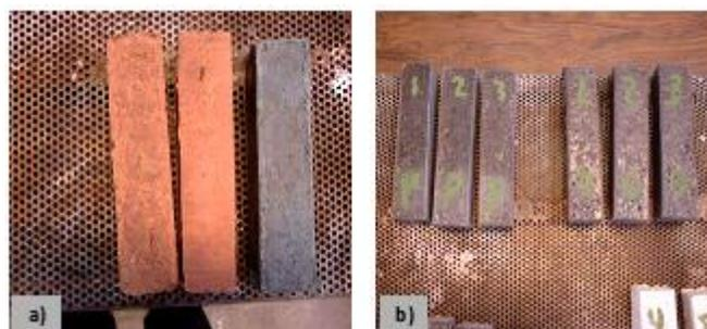
**Tabla 3.** Materiales Compuestos refractarios: (a) Plástico refractario, y (b) Concreto refractario.
