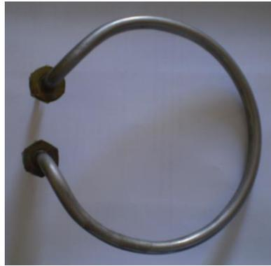
**Figura 10: Resistência utilizada no projeto**
