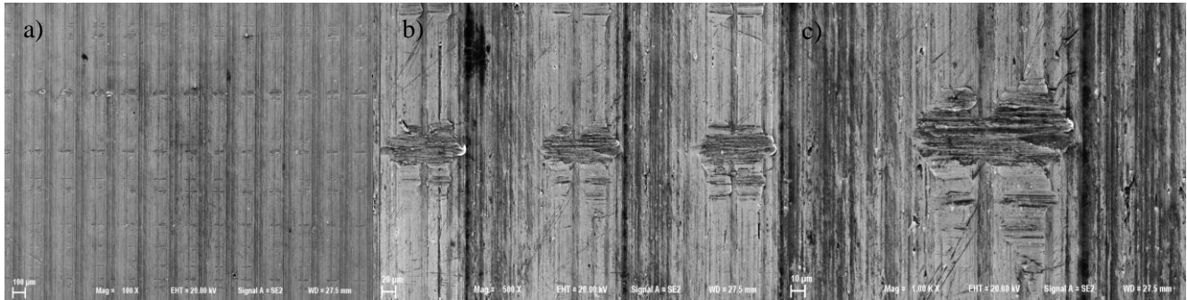
Figuras 11 - Imagem da superfície da peça de alumínio obtida no MEV após a medição da rugosidade, a) escala 100 μm, b) escala 20 μm e c) escala 10 μm
