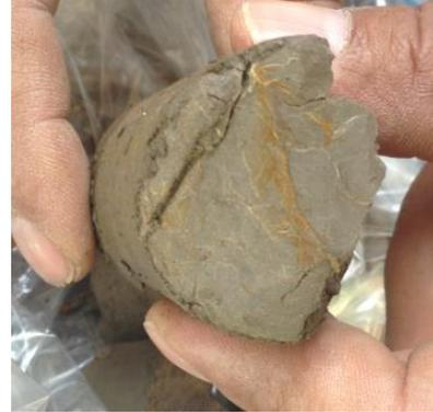
Figura 3. Aspecto de una muestra superficial de de limo arcilloso con oxidaciones y raíces.
