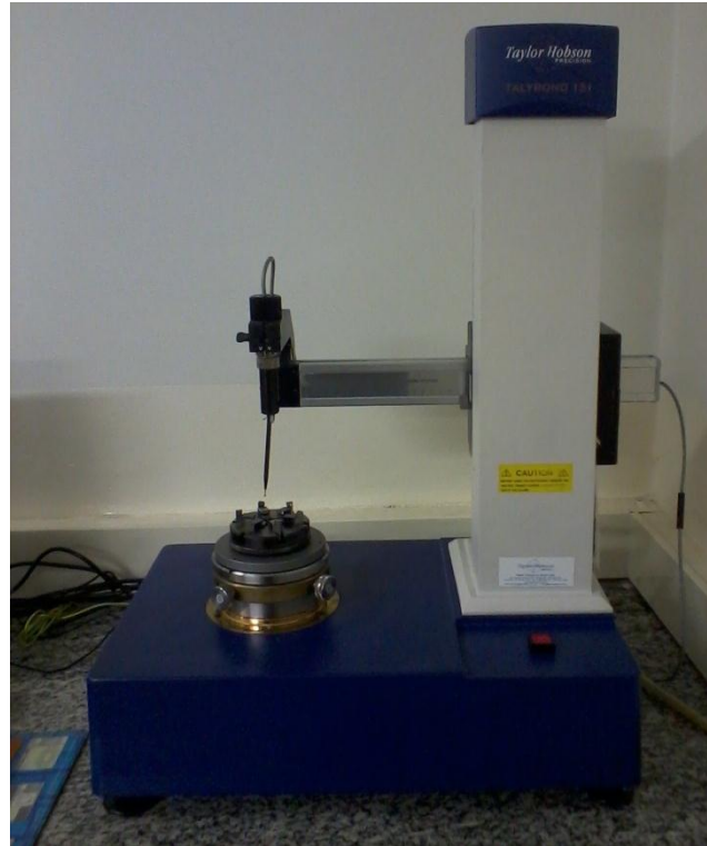
Figura 3: (a) máquina de medir a três coordenadas; (b) máquina de medir desvios de forma
