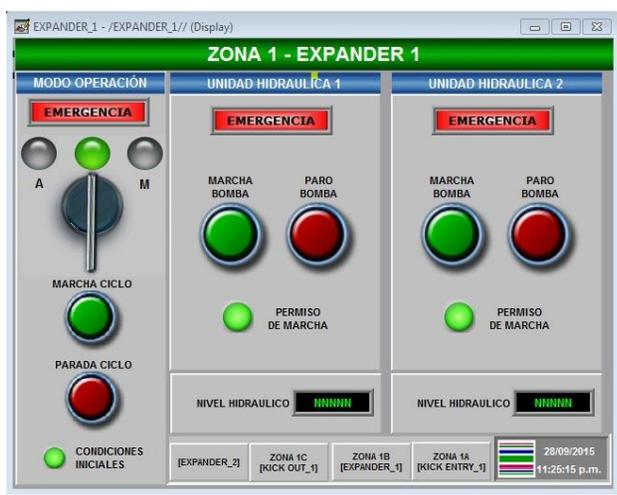
Fig 6. Aplicación Operativa HMI.
