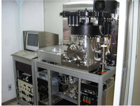
Figure 1 - Visão geral da câmara de deposição dos filmes-reator de ECR.
