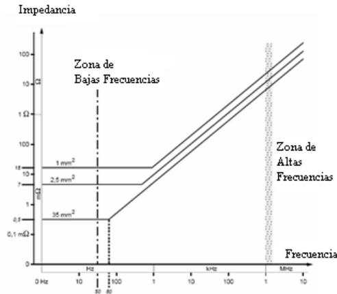
**Figura 3. Valores característicos de la impedancia de un conductor eléctrico de longitud  $L=1m$ .**
