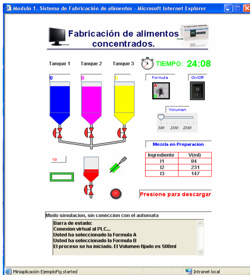
Figura 6 Ventana de Control y Monitorización
