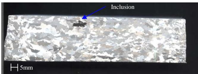
**Figura 2. Macroestructura Experimento 2, flujo de calor hacia la derecha.**
