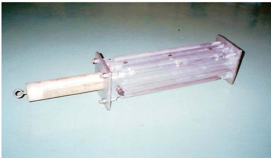
Figura 5: Prototipo magnético disipador pasivo de energía sísmica fabricado
