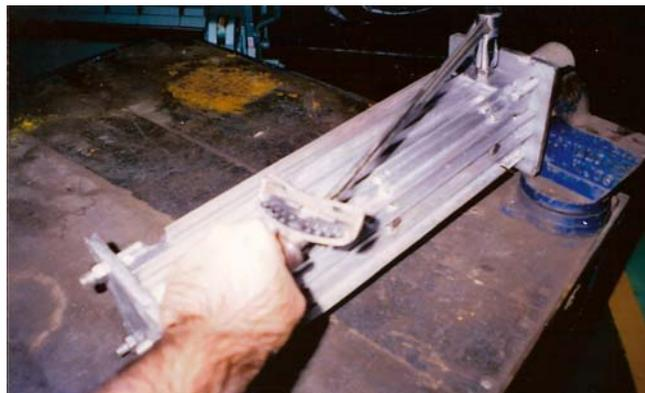
Figura 3: Calibración de apriete de tornillos reguladores
