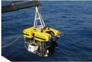
**Figura 1: Vehículo submarino no tripulado (ROV) Hércules**
