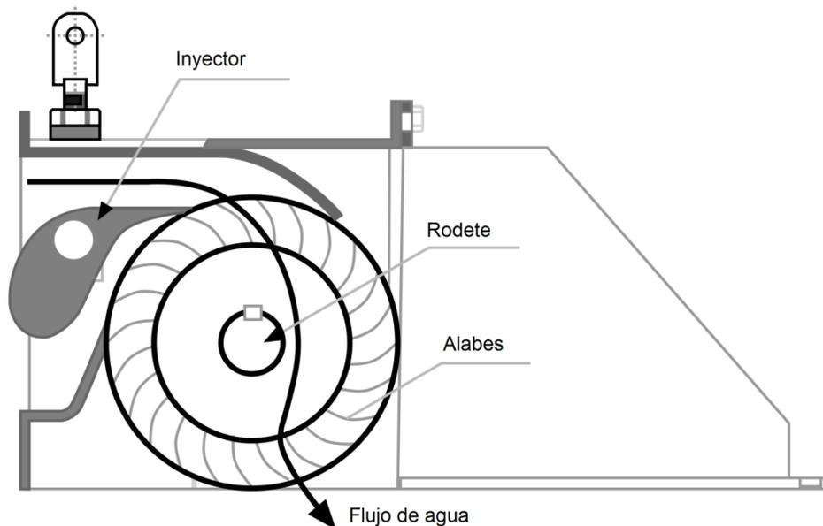
**Figura 2. Componentes Principales de la Turbina Michell-Banki**
