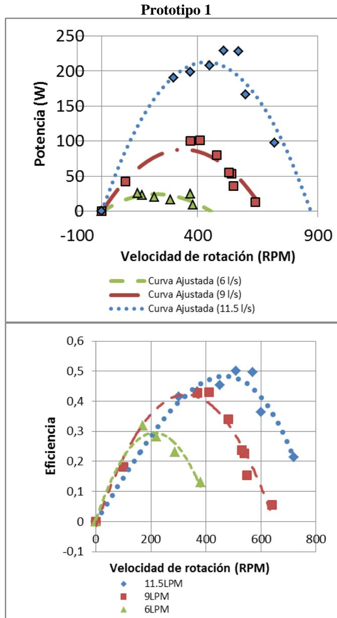
*Figura 4. Resultados Obtenidos en las Pruebas de Funcionamiento del Prototipo 1*
