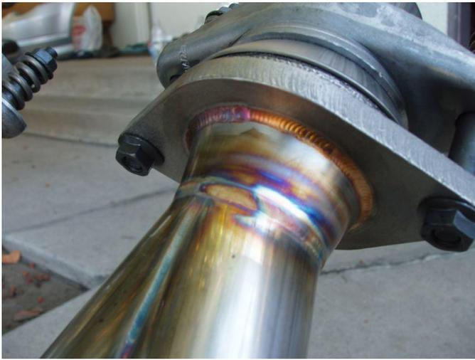
Fig. 2 Ejemplo de Soldadura GTAW
