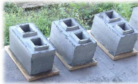
Figura 3: Fraguado y Curado del Bloque
