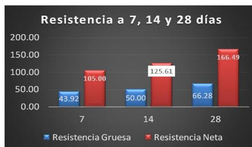
Gráfico 1: Relación de resistencia entre bloques de hormigón tradicional y Level Block
