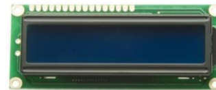
Fig. 5 Pantalla LCD 16x2 Fuente: [Propia]
