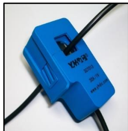
Fig. 6 Sensor de Corriente Conectado Fuente: [Propia]
