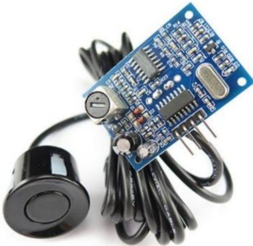
El microcontrolador Arduino UNO R3 está programado con una adaptación del lenguaje de programación C++. EL programa tiene por objetivo medir el tiempo que tarda el sonido producido por el transductor en recorrer una distancia determinada (la distancia desde la cascara de la fruta hasta su semilla), y en función de los rangos establecidos activar el indicador LED correspondiente.
