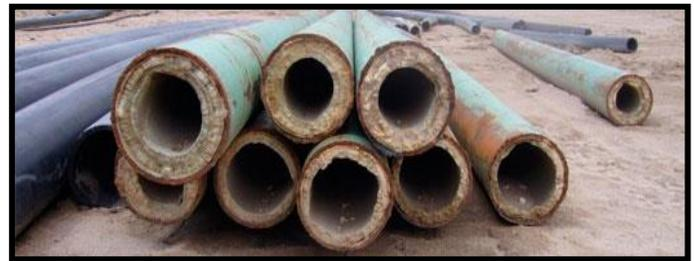
Fig. 1 Incrustaciones en las tuberías de las calderas
