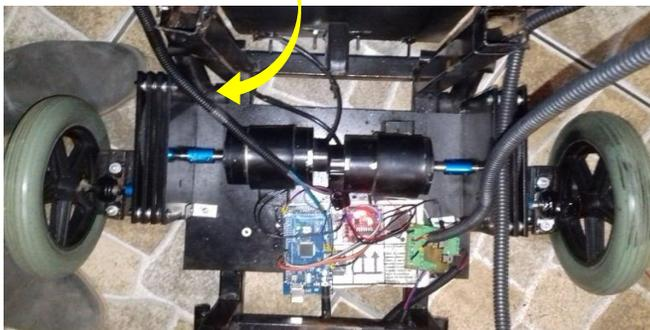
Figura 1: Estructura mecánica de las ruedas y electrónica de control (Fuente: Elaboración propia)
