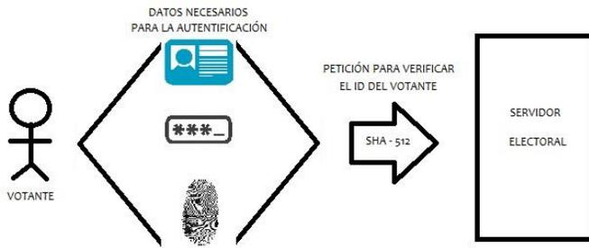
Fig. 7 Verificación de datos de identidad. El servidor electoral verifica si los datos ingresados por el votante son correctos mediante el uso del SHA-512.
