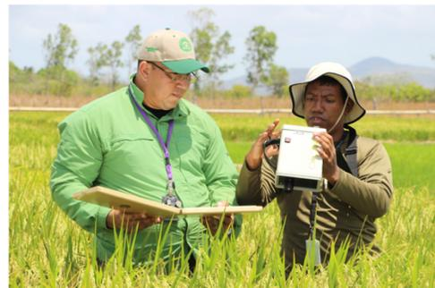
Fig. 2 - Adquisición de firmas espectrales de un cultivo con el uso del espectrorradiómetro.
