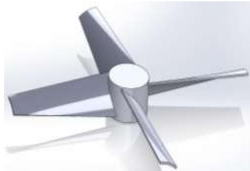
Fig. 7 Simulación del propulsor RTF4 en SolidWorks.
