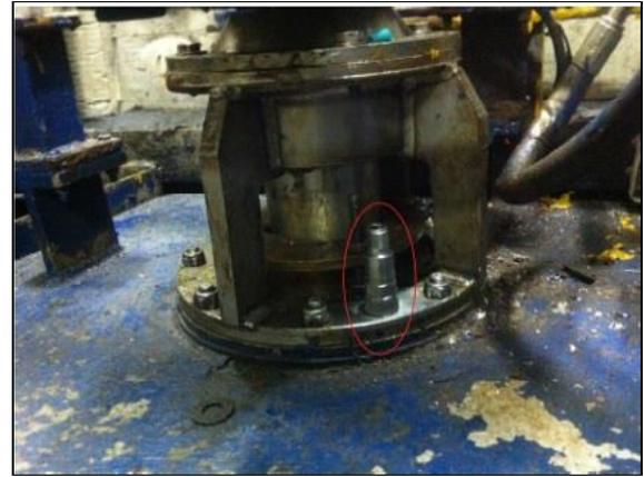
Figura 9. Posicionamiento del acelerómetro en la máquina de gobierno.
