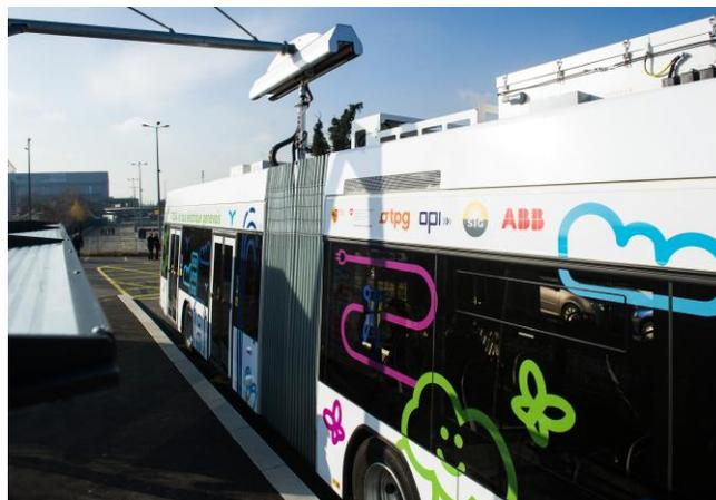
Fig. 5. Estación de carga rápida TOSA de ABB. Extraído de [19]
